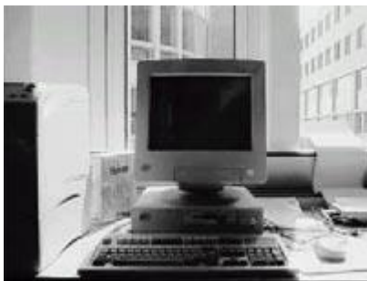
Figura 7 - Posto di lavoro al videoterminale con condizioni di luce sfavorevoli: eccessivo contrasto di chiaro-scuro fra lo schermo e lo sfondo
